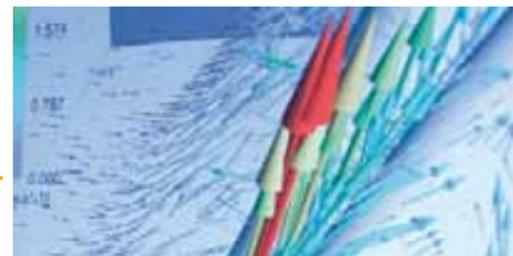
Geschwindigkeitsvektoren einer Strömungssimulation
