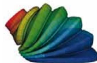
Simulation des Einfeder- und Einlenkverhaltens
